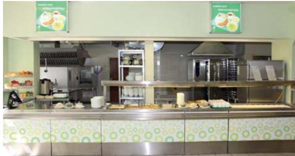
Рис.39 Линия раздачи со стационарными мармитами
